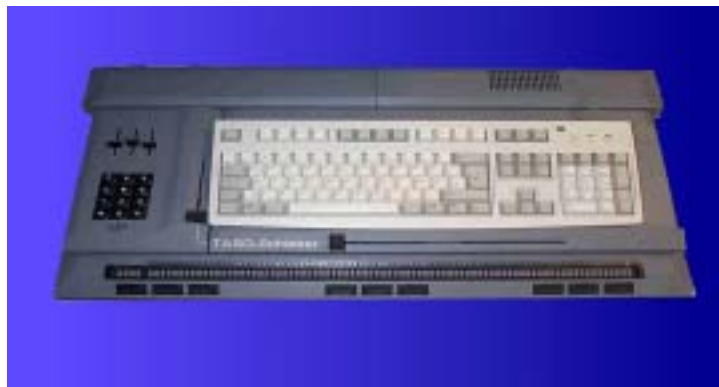
Abbildung 5: Braillezeile von AUDIODATA mit "TASO"-Schiebern (gezeigtes Modell ersetzt mit Typ BM 80)
